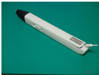
樹脂ドライバーで Door を外せます
