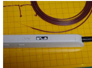
取り出したフィラメント(下地カプトン) (先が伸びて細くなっています)
