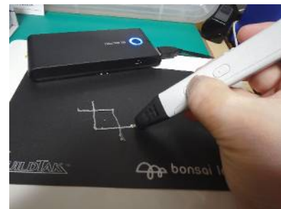
5V/2AのUSBバッテリーで動作中 (ダビンチ用 ABS フィラメントを利用)
